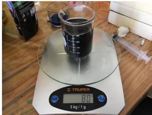
Figura 1. Medición de la masa y volumen del jabón líquido para obtener su densidad.
