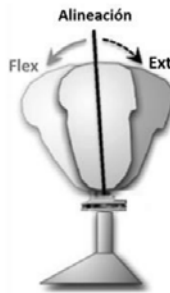
Figura 4. Variación de la ubicación angular del encaje de la prótesis transtibial.
