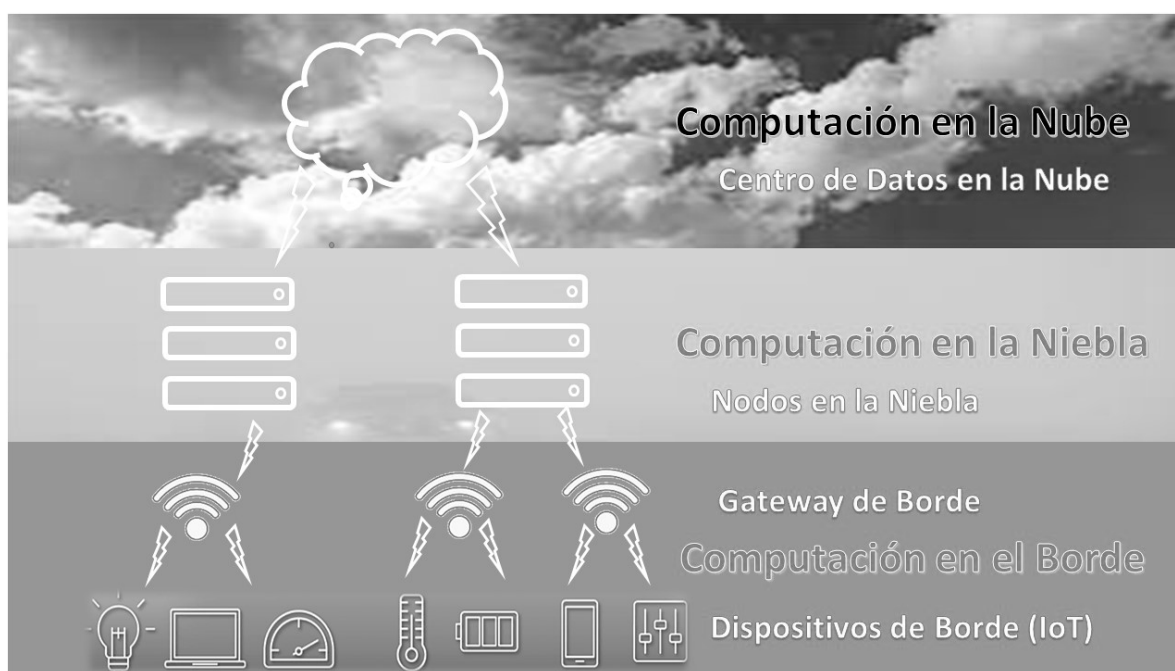
Figura 1. Comparación entre Computación en la Nube, FC y EC. Fuente: Hurtado y Ramos (2021).
