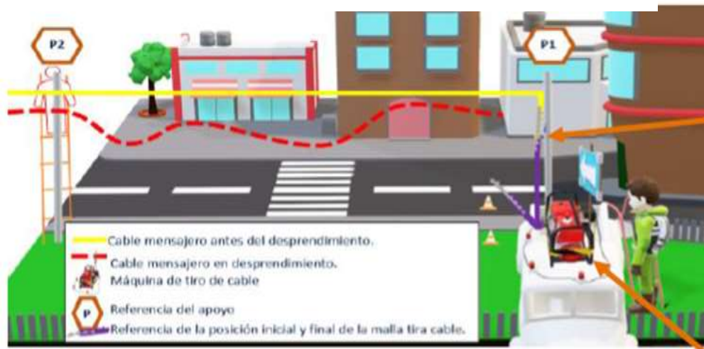
Figura No.6 Tendido del cable
