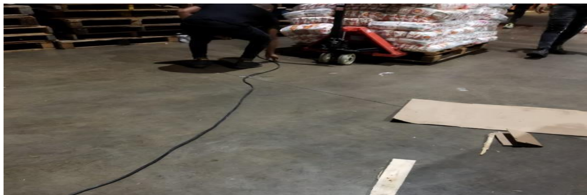
Figura 35 Cables en mala posición que obstaculizan el proceso de descarga.
