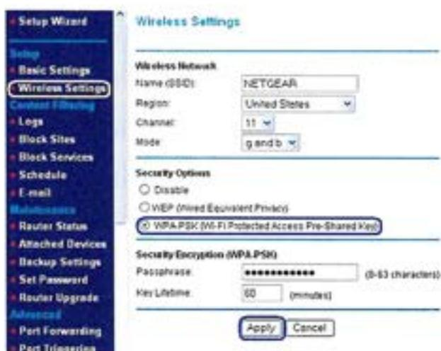
Nota. Ejemplo de configuración de seguridad inalámbrica WPA-PSK en un router Netgear. De Netgear, 2024, NETGEAR Wireless Router Setup Guide ([https://wwwdownloads.netgear.com/files/GDC/WNR2000/WNR2000\\_UM\\_19Apr11.pdf](https://wwwdownloads.netgear.com/files/GDC/WNR2000/WNR2000_UM_19Apr11.pdf)). Copyright 2024 por Netgear, Inc.
