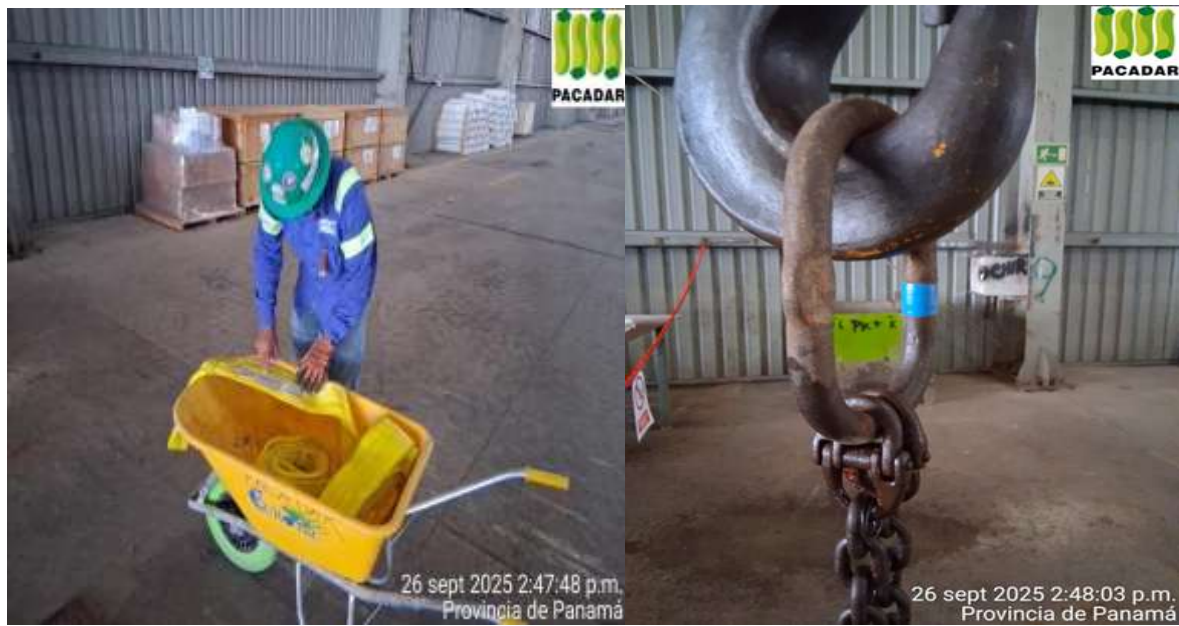
Figura 70. Se mantiene inspección de equipos, así como accesorios de izajes los mismos se inspeccionan cada mes como el protocolo de seguridad de la obra. (Autoría propia)
