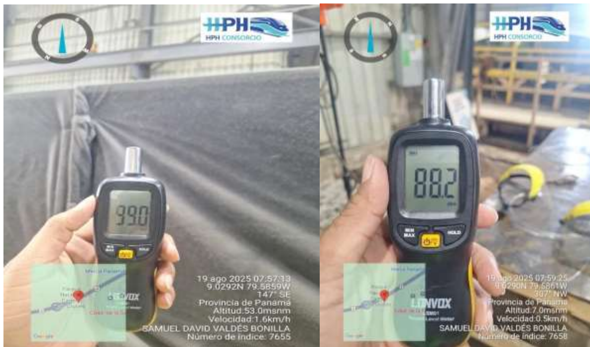
Figura 19. Se realiza medición de ruidos en la galera la medición arroja que los niveles son los ya identificados para el uso de EPP. Auditivo. (Autoría propia)
