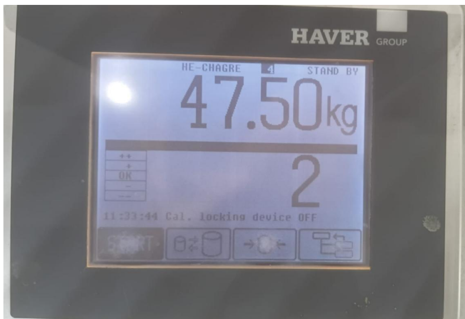
Figura 3: Saco de cemento con peso fuera de la especificación nominal.
