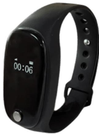
Figura N°10 Pulsera Bluetooth de monitoreo. Se enlaza con el sensor del casco Lansitec.
