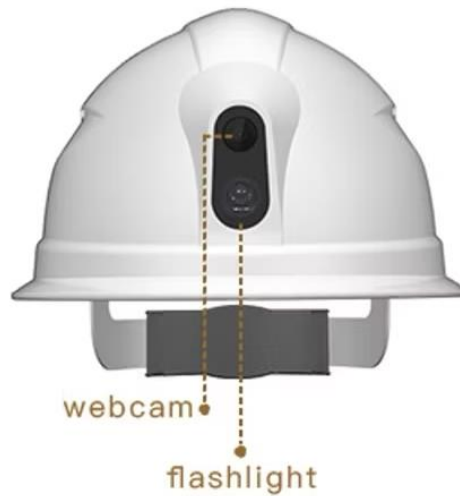
Figura N°8 Casco de Protección Personal Inteligente de sistema Android.
