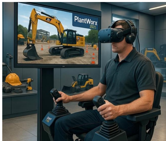
Figura N°6 Simulador de realidad virtual para capacitación en manejo de excavadoras.
